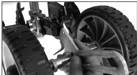
Рис. 6 Установка кронштейна колес
