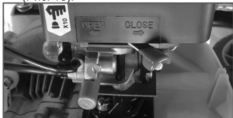
Рис. 16 Воздушная заслонка карбюратора закрыта
