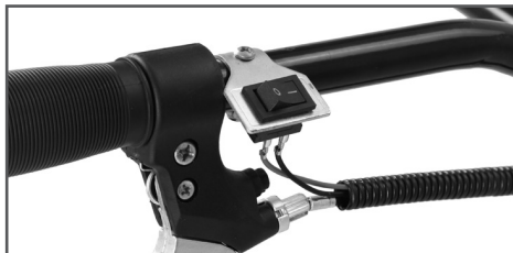
Рис. 13 Подключение проводов к выключателю зажигания
