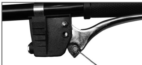
Рис. 9 Установка наконечника троса газа
