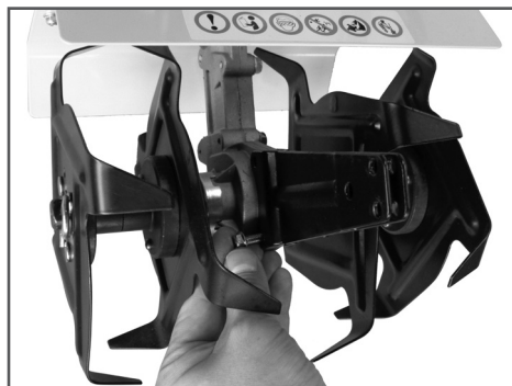
Рис. 5 Установка кронштейна сошника
