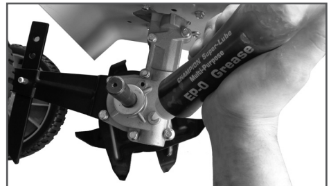
Рис. 24 Добавление смазки в корпус редуктора
